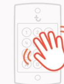
Um Energie zu sparen, wechselt K300 nach einer Minute in den Ruhezustand, wodurch die Hintergrundbeleuchtung und die LEDs von K300 ausgeschaltet werden. K300 verfügt über einen Näherungssensor mit einer Reichweite von wenigen Zentimetern, der die Hand des Benutzers erkennt und K300 aktiviert. So können Benutzer die Tasten auch bei schlechten Lichtverhältnissen sehen.
